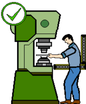
Protezione orizzontale e verticale
